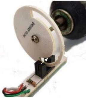
Aumente o furo central se necessário, e prenda o disco aplicando torque moderado para que eventual folga no eixo não danifique o sensor.
